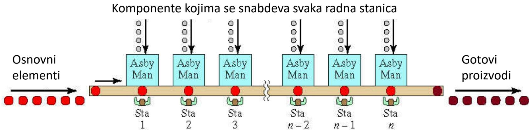
Konfiguracija montažne linije sa  $n$  radnih stanica sa manuelnim radom
